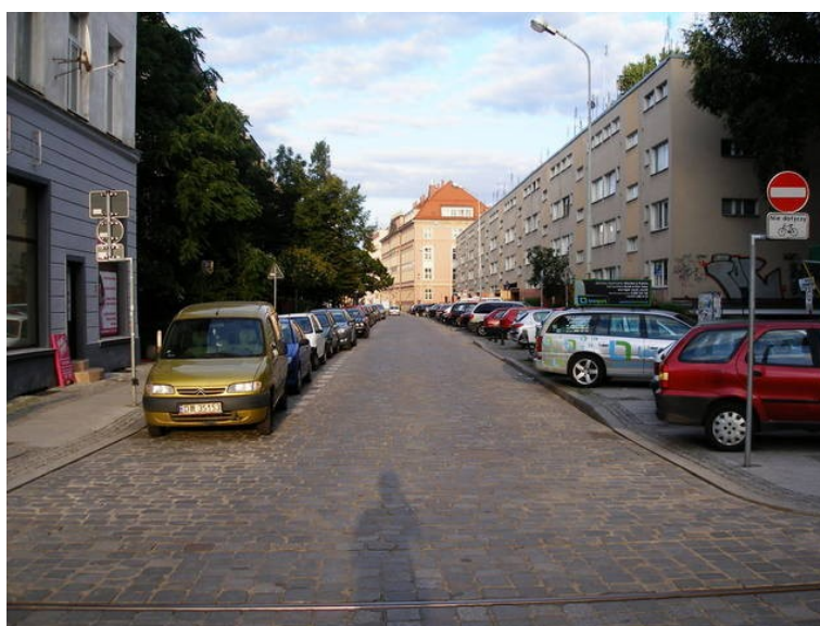
Fotografia 16. W wielu przypadkach można także dopuścić ruch rowerów pod prąd bez wyznaczania specjalnego pasa (Wrocław)
