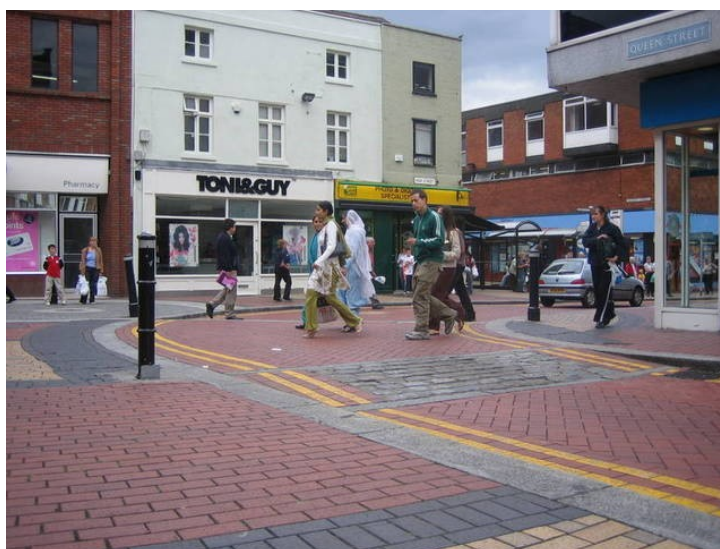
Fotografia 18. Płytkowe progi spowalniające, łagodniejsze a jednocześnie skuteczniejsze od listwowych (Maidenhead, Wlk. Brytania)
