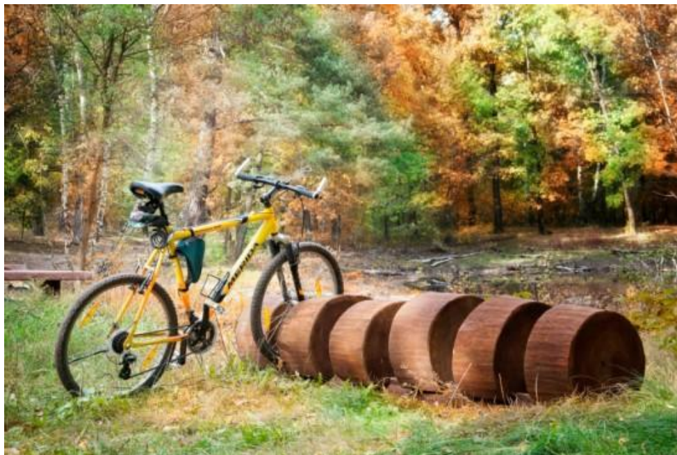
Rysunek 53. Przykładowy „leśny” stojak rowerowy. Uwaga: stojak nie umożliwia zapięcia i pozostawienia roweru.
