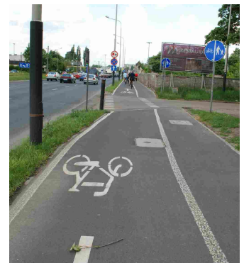
Łódź. Prawidłowa geometria drogi dla rowerów przed przejazdem dla rowerzystów.
