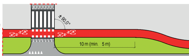
SCHEMAT 29. Dodatkowe oznakowanie przejazdu dla rowerzystów.
