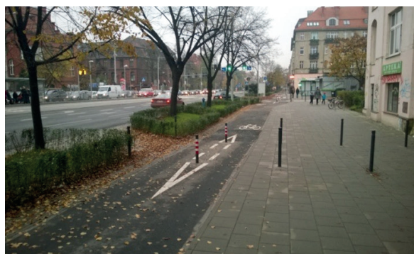
ZDJĘCIE 65. Polska, Wrocław. Słupki blokujące przed wjazdem samochodów.
