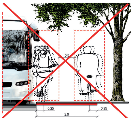
Błędne rozwiązanie - dwukierunkowa droga dla rowerów bez odsunięcia od jezdni.
